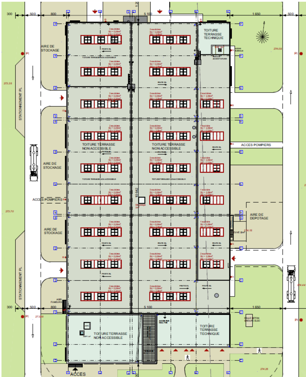
Figure 15 : Localisation des dispositifs de désenfumage
